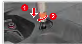
Utilisez un tournevis à tête plate, et tournez de 90 degrés dans le sens horaire pour verrouiller.
