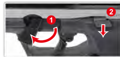
Gire la palanca de desmontaje y presione el tope deslizante.
