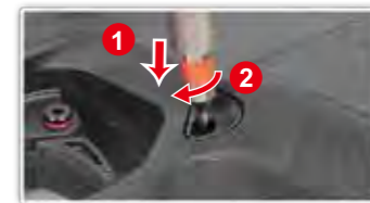
Empuje hacia abajo el tornillo con un destornillador , luego gire 90 grados en sentido horario para bloquear.
