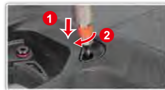
使用一字起子將彈匣釋放鈕壓下並順時針旋轉90度旋緊螺絲。
