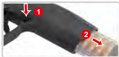
1. Jalar hacia abajo la palanca liberadora de cargador. 2. Remueva el cargador.
