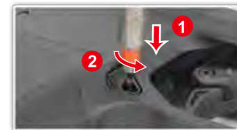
Empuje hacia abajo el tornillo con el destornillador de , luego gire 90 grados en sentido antihorario.
