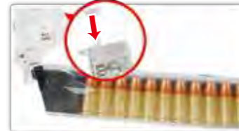
使用隨槍附贈的填彈器填滿BB彈至彈匣中。
