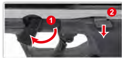
旋轉分解桿至下方後向下推動後定桿。
