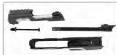
Limpie las piezas desmontadas y lubrique con aceite de silicio.
